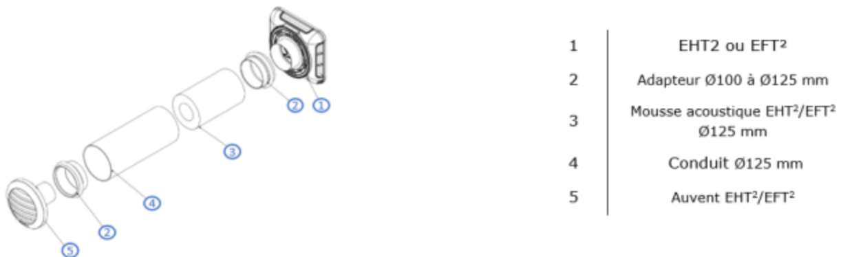
Figure 26 – Mise en œuvre des entrées d'air EHT 2 et EFT 2 en conduit Ø 125 mm L 300 mm
