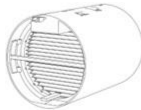
Figure 23 - Électrofiltre EHT 2 /EFT 2
