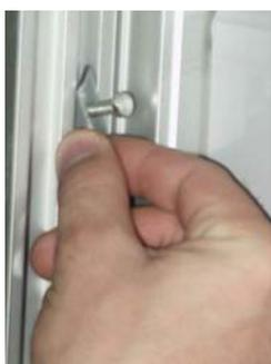
4- Placer les inserts avec les vis dans la rainure du profil.
