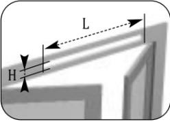
Le respect du dimensionnement de la fente est impératif pour garantir le débit de l'entrée d'air. La fente doit être percée à l'usine de fabrication des menuiseries et non sur le chantier.
