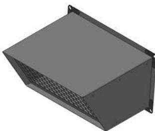
Les auvents sont fournis avec des vis M8 et un joint autocollant de section 10x20 mm en EPDM. Coller le joint sur la bride de l'auvent afin de garantir l'étanchéité de la structure.
