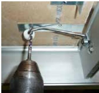
7. Riveter le rail de guidage sur le vantail avec le rivet L47 + rondelle au dos du vantail.
