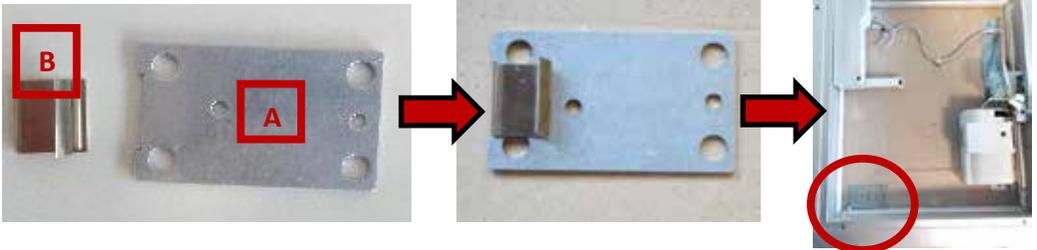
**2 :** Venir positionner l'ensemble A et B sur le volet en veillant à bien respecter le sens de montage puis viser le tout sur le volet. Couple de serrage : 1N.m
