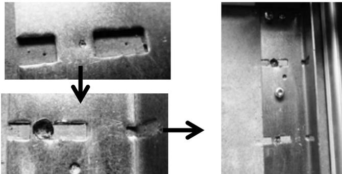
*Positionner moteur et le fixer avec 2 vis auto foreuses [Nécessite utilisation d'un embout de vissage long]
