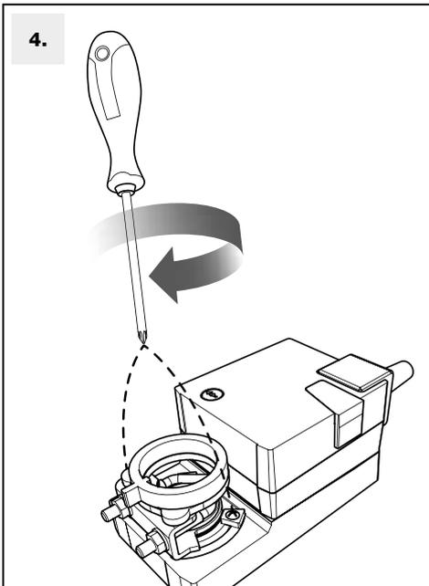
5. Régler Qmin et Qmax par itération en vissant / dévissant les butées du moteur selon la graduation de débit du MR Max.
