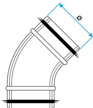
Esquema dimensiones Codo 45° con juntas
