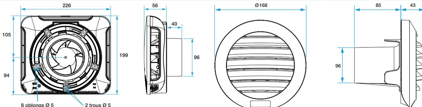
Encombrement Entrée d'air EHT<sup>2</sup> et EFT<sup>2</sup>
