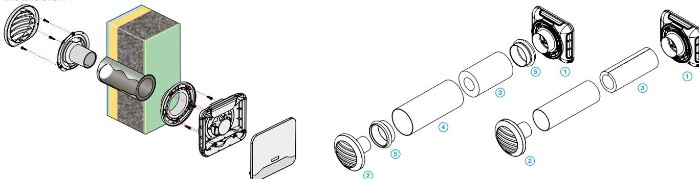
Montaje entrada de aire EHT<sup>2</sup> y EFT<sup>2</sup>
